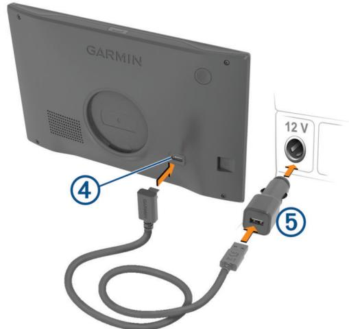
4 將車用電源線的另一端插入車用電源變壓器 **⑤**。
