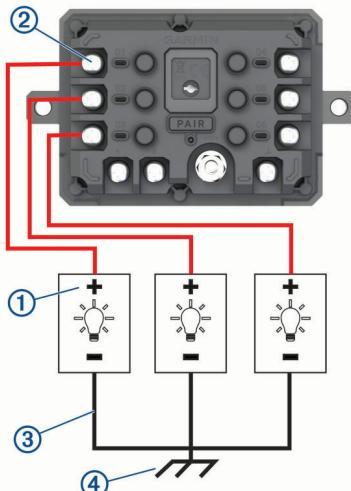
**2** Подсоедините отрицательный провод или провод «массы» **③** к неокрашенной шпильке «массы» **④** на раме транспортного средства, к распределительному блоку «массы» или напрямую к отрицательной клемме аккумуляторной батареи.
