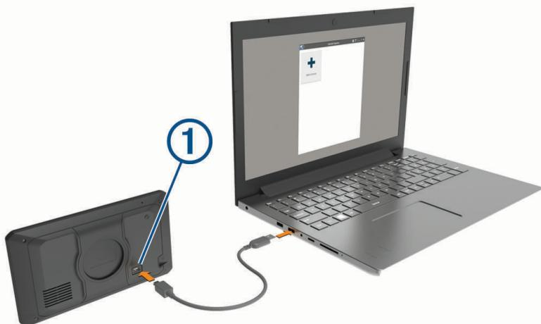
4 На устройстве dēzl выберите **Коснитесь, чтобы подкл. к комп..**
