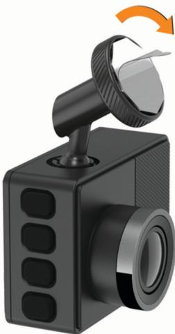
**3** Coloque o suporte na posição de montagem.
