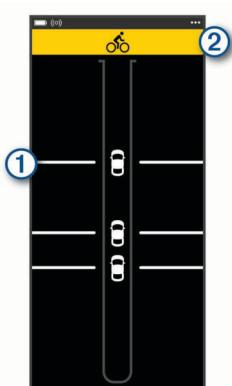
O ① de posicionamento do veículo se move para cima da tela conforme o veículo se aproxima da bicicleta. O banner de nível de ameaça ② muda de cor com base no nível potencial da ameaça. Verde indica que nenhum veículo foi detectado. Âmbar indica que um veículo está se aproximando. Vermelho indica que um veículo está avançando a uma velocidade elevada.
