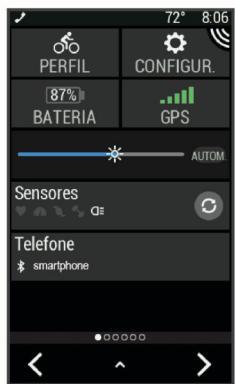
O widget de configurações é exibido. O ícone intermitente significa que o dispositivo está procurando sinal. Um ícone sólido significa que o sinal foi encontrado ou sensor está conectado. Você pode selecionar qualquer ícone para alterar as configurações.
