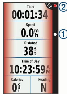
O LED de posicionamento do veículo ① se move para cima conforme o veículo se aproxima da bicicleta. O LED de nível de ameaça ② muda de cor com base no nível potencial da ameaça. Verde indica que nenhum veículo foi detectado. Âmbar indica que um veículo está se aproximando. Vermelho indica que um veículo está avançando a uma velocidade elevada.
