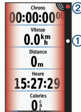
Le voyant DEL de position du véhicule ① progresse dans la colonne à mesure qu'un véhicule se rapproche de votre vélo. Le voyant DEL de niveau de menace ② change de couleur selon le niveau potentiel de menace. Le vert indique qu'aucun véhicule n'est détecté. L'orange indique qu'un véhicule est en approche. Le rouge indique qu'un véhicule roulant très vite se rapproche de vous.
