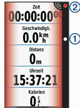
Die Fahrzeugpositions-LED ① rückt in der Lichtleiste immer weiter nach oben, je näher sich das Fahrzeug Ihrem Fahrrad nähert. Die Gefahrenstufen-LED ② ändert die Farbe basierend auf der möglichen Gefahrenstufe. Grün bedeutet, dass kein Fahrzeug erkannt wurde. Gelb bedeutet, dass sich ein Fahrzeug nähert. Rot bedeutet, dass sich ein Fahrzeug sehr schnell nähert.
