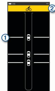
Die Fahrzeugposition ① rückt auf der Seite immer weiter nach oben, je näher sich das Fahrzeug dem Fahrrad nähert. Das Gefahrenstufenbanner ② ändert die Farbe basierend auf der möglichen Gefahrenstufe. Grün bedeutet, dass kein Fahrzeug erkannt wurde. Gelb bedeutet, dass sich ein Fahrzeug nähert. Rot bedeutet, dass sich ein Fahrzeug sehr schnell nähert.
