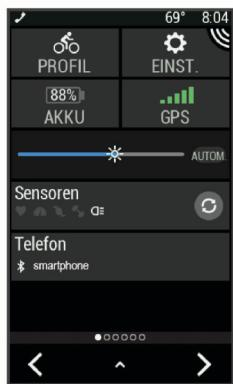
Das Einstellungs-Widget wird angezeigt. Wenn ein Icon blinkt, sucht das Gerät ein Signal. Wenn das Icon leuchtet, wurde das Signal gefunden oder der Sensor ist verbunden. Sie können ein beliebiges Symbol auswählen, um die Einstellungen zu ändern.
