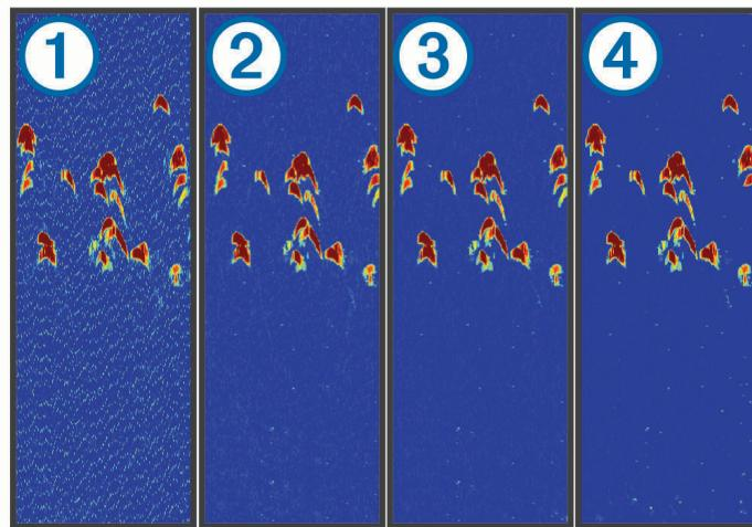
간섭 설정을 꺼짐①에서 낮음②, 중간③ 및 높음④으로 조정하면 잡음은 점차 제거되지만 강한 타겟 반향에 영향이 거의 없습니다. 화면에서 간섭을 제거하기 위해서는 원하는 개선을 얻는 가장 낮은 간섭 설정을 사용해야 합니다. 잡음을 일으키는 설치 문제를 수정하는 것은 간섭을 제거하는 가장 좋은 방법입니다.
