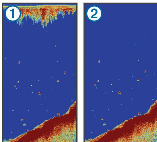
표면 잡음①은 변환기와 물 사이의 간섭에 의해 발생합니다. 불요 반사파를 줄이는 데 도움이 되도록 표면 잡음②을 숨길 수 있습니다. 빔 너비가 크면(낮은 주파수) 더 많은 타겟을 표시하지만 그만큼 표면 잡음이 많이 발생합니다.
