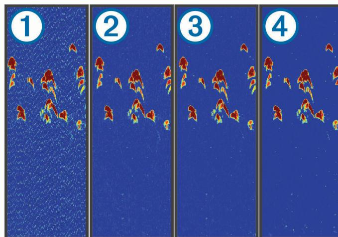
Wenn Sie die Störungseinstellungen von „Aus“ ① über „Niedrig“ ②, „Mittel“ ③ und „Hoch“ ④ anpassen, werden Störungen schrittweise entfernt. Die starken Echolotsignale werden dadurch aber kaum beeinflusst. Sie sollten die niedrigste Störungseinstellung verwenden, bei der die gewünschte Verbesserung erzielt wird, um Störungen vom Bildschirm zu entfernen. Störungen lassen sich am besten vermeiden, indem montagebedingte Probleme beseitigt werden, die Störungen verursachen.
