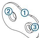
O outro orifício **3** da placa de retenção deverá ser alinhado com o orifício menor do modelo.
