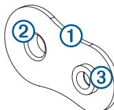
如果您使用的是螺帽片，則螺帽片上的較小孔洞 ③ 應該與模板上的較小孔洞對齊。
