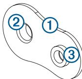
ナットプレートを使用する場合は、ナットプレートの小さい穴③をテンプレートの小さい穴に合わせてください。
