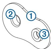
Si estás utilizando una placa de tuerca, el orificio más pequeño ③ de la placa de tuerca se debe alinear con el orificio más pequeño de la plantilla.
