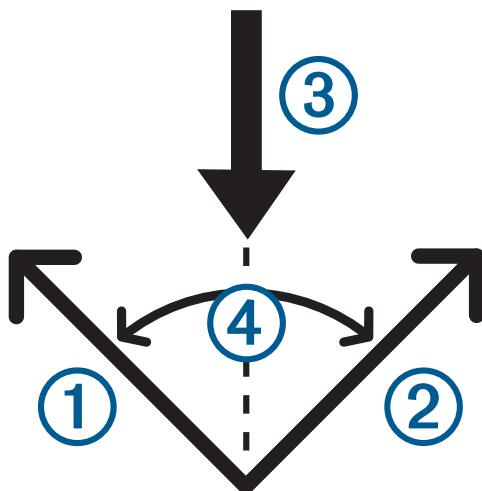
Anhand dieser Daten ermittelt die Uhr, ob sich das Schiff aufgrund einer Änderung der Windrichtung im Anlufen oder Abfallen befindet.
