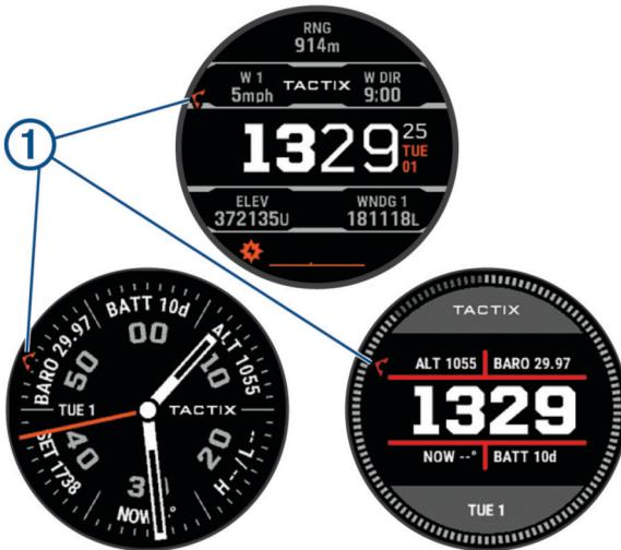
**1** Стрелка всемирного координированного времени (UTC). Отображается при выборе циферблата на 24 деления.
