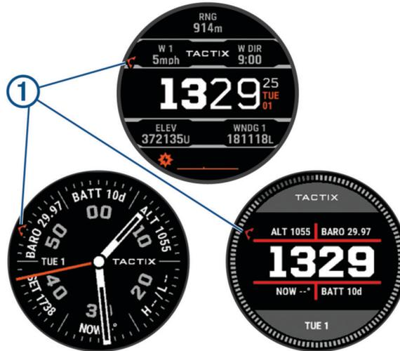
① Aiguille du temps universel coordonné (UTC). Indique les marqueurs pour lire l'heure au format 24 heures sur la montre.
