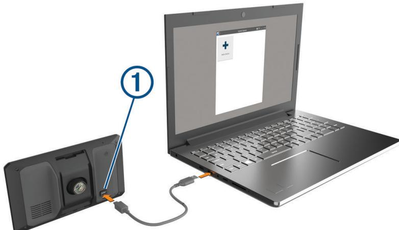
4 dēzlCam デバイスでタップしてコンピュータに接続します選択します。
