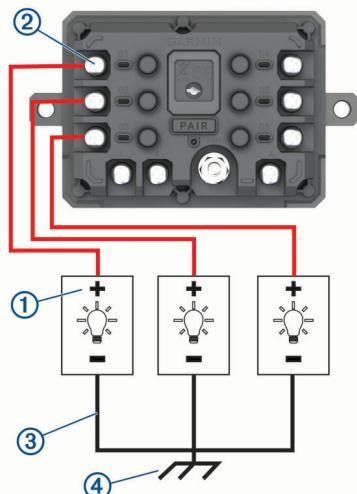
2 将负极线或接地线 ③ 连接到车辆框架上未上漆的接地柱 ④、接地分配块，或直接连接到电池的负极端子。
