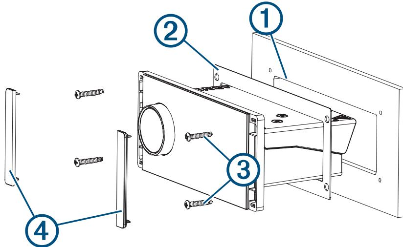
**4** 确保立体声音响上的安装孔与模板上的定位孔对齐。
