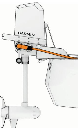
電源ケーブルストレインリリーフは、モーターハウジングのクレードルに接触して取り付けられています。
