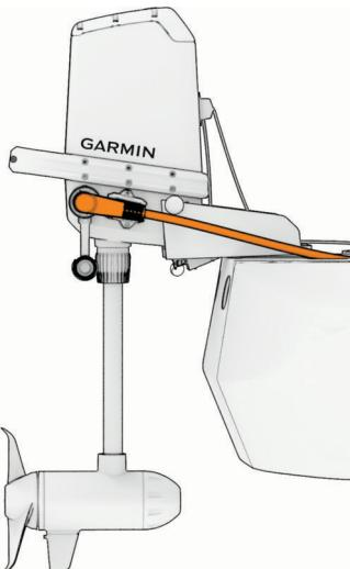
Pelepas ketegangan kabel daya disandarkan pada dudukan di atas rumah motor.
