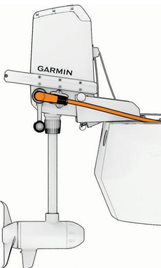
El liberador de tensión del cable de alimentación se apoya contra el soporte de sujeción de la carcasa del motor.
