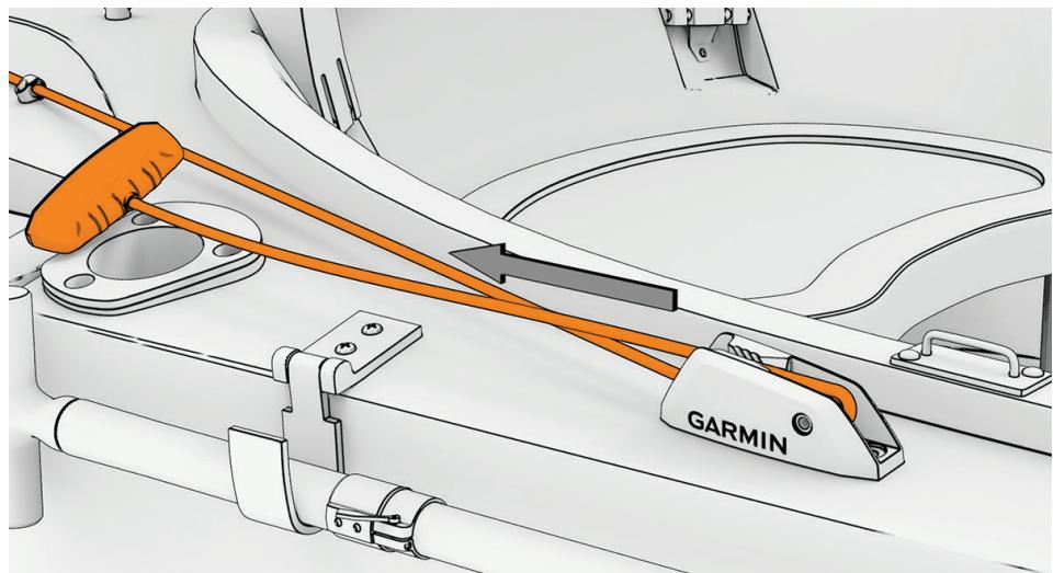
La cuerda se fija bajo tensión en la mordaza, manteniendo el motor en la posición de recogida.
