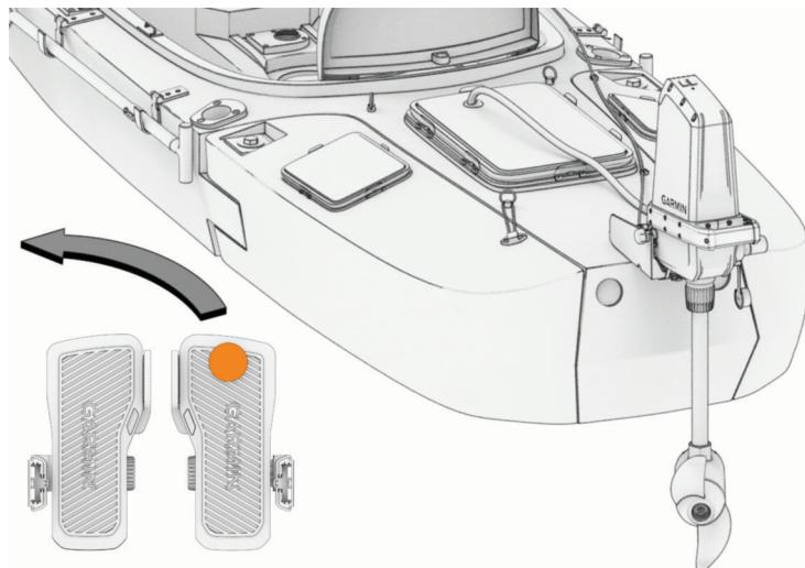
La punta del motor de accionamiento de la hélice gira hacia la derecha, girando el kayak hacia la izquierda.
