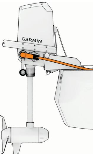
Die Zugentlastung des Netzkabels liegt an der Halterung am Motorgehäuse.
