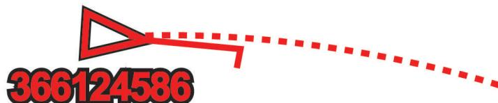
如果已激活 AIS 目标提供对地航向和航向信息，但是未提供转弯率信息，目标的设计路线将根据对地航向信息计算。
