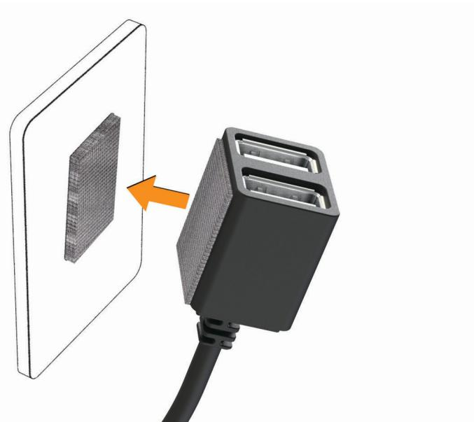
8 Подключите кабель питания USB на устройстве Garmin Dash Cam к порту USB на устройстве Constant Power Cable.
