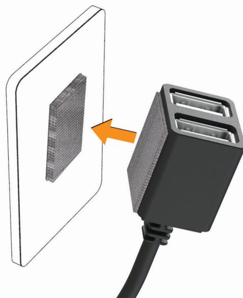
8 Verbinden Sie das USB-Netzkabel vom Garmin Dash Cam Gerät mit einem USB-Anschluss am Constant Power Cable.
