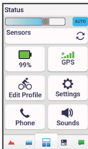
Viene visualizzato il widget dello stato. Un'icona lampeggiante indica che il dispositivo sta effettuando una ricerca. Un'icona fissa indica che il segnale è stato trovato o che il sensore è connesso.
