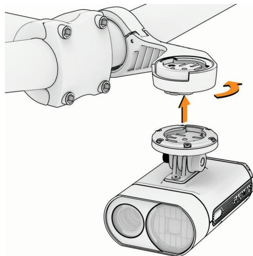
**11** Regolare l'angolazione del fanale anteriore in modo che sia parallelo al suolo e utilizzare la chiave a brugola da 4 mm per serrare la vite.
