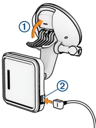
2 将车辆电源线插入到固定架上的端口 ② 中。
