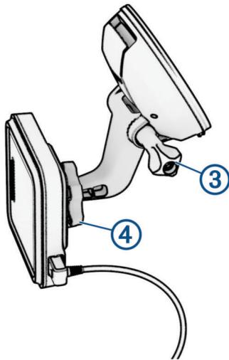
4 拧紧吸盘臂上的指旋螺钉和球形固定装置上的螺母。
