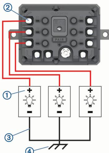
**2** Collegare il cavo negativo o di massa **③** a un prigioniero di massa non verniciato **④** sul telaio del veicolo, a un blocco di distribuzione della massa o direttamente al terminale negativo della batteria.
