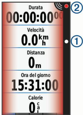
Il LED di posizione del veicolo ① si illumina mano a mano che un veicolo si avvicina alla bici. Il LED del livello di pericolo ② cambia colore in base al potenziale livello di pericolo. Il verde indica nessun veicolo è rilevato. Ambra indica un veicolo in avvicinamento. Rosso indica che un veicolo sta avanzando ad alta velocità.
