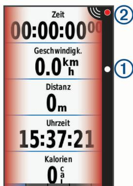
Die Fahrzeugpositions-LED **①** rückt in der Lichtleiste immer weiter nach oben, je näher sich das Fahrzeug Ihrem Fahrrad nähert. Die Gefahrenstufen-LED **②** ändert die Farbe basierend auf der möglichen Gefahrenstufe. Grün bedeutet, dass kein Fahrzeug erkannt wurde. Gelb bedeutet, dass sich ein Fahrzeug nähert. Rot bedeutet, dass sich ein Fahrzeug sehr schnell nähert.
