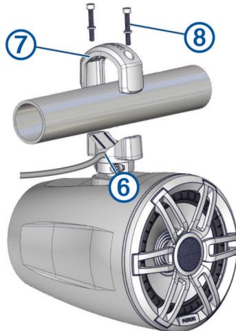
8 Coloca la parte superior del soporte **⑦** sobre la barra antivuelco y sostenla sobre la base del soporte.
