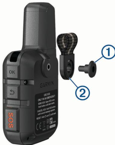
2 Prenda o adaptador do sistema de montagem ① sobre a parte de trás do dispositivo usando o parafuso longo ② incluído com o dispositivo.
