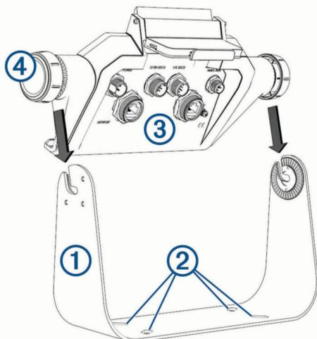
3 使用安裝硬體適用的鑽頭，鑽出四個引導孔。
