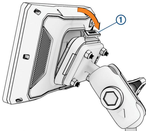
2 Надавите на верхнюю часть устройства, чтобы закрепить его в подставке. При правильной установке должен быть слышен характерный щелчок.
