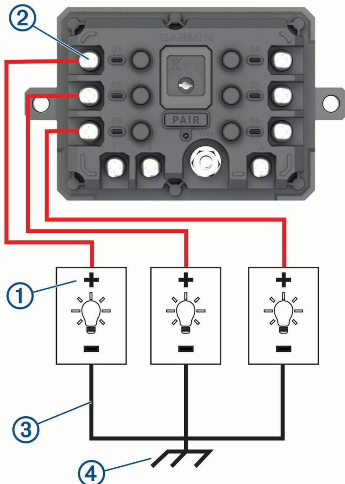
**2** Ligue o cabo negativo ou de terra **③** a um perno de terra não pintado **④** na estrutura do veículo, a um repartidor de terra ou diretamente ao terminal negativo na bateria.
