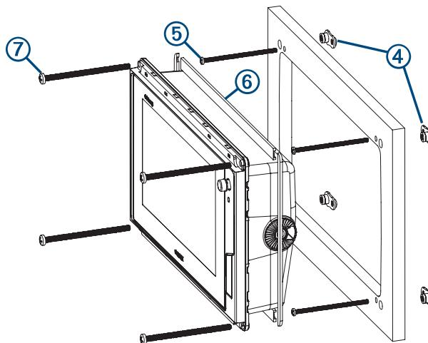
17 將較小的機械螺絲⑤穿過較小的孔洞並加以鎖緊，讓螺帽片固定在安裝表面上。
