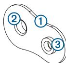
螺帽片上的較小孔洞 ③ 應該與模板上的較小孔洞對齊。
