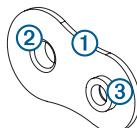
托板螺母上的小孔 ③ 应与模板上的小孔对齐。
