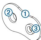
Le trou le plus petit ③ sur la platine doit être aligné sur le plus petit trou du modèle.
