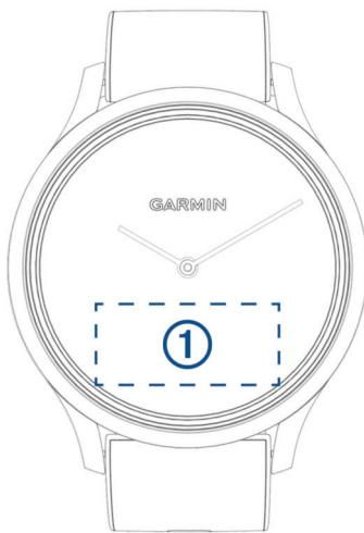
**Tocar duas vezes:** toque duas vezes na tela sensível ao toque ① para ativar o dispositivo.
