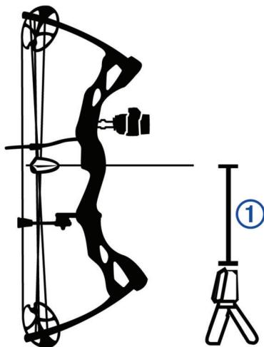
Das Gerät erkennt Schüsse und zeigt Messwerte automatisch beim Schießen an. Bei der gemessenen Geschwindigkeit handelt es sich um die Geschwindigkeit des Pfeils, während er über den Chronographen fliegt.
