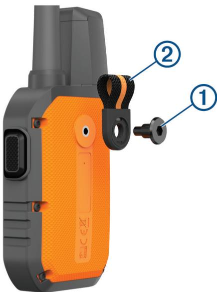
2 Fixez l'adaptateur pour fixation à rainure ① au dos de l'appareil à l'aide de la grande vis ② incluse avec l'appareil.
