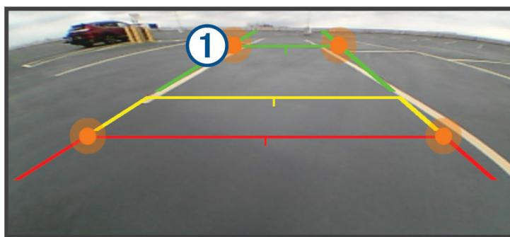
**4 Si besoin, restationnez le véhicule en alignant étroitement l'autre côté à un trottoir, une allée ou les lignes d'une place de parking, et répétez la procédure d'alignement.**
