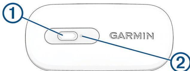
El LED ② parpadea cuando está activo y utilizando una conexión segura.
