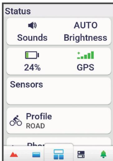
Aparece el widget de estado. Si el ícono parpadea, significa que el dispositivo está buscando señal. Si el ícono permanece fijo, significa que se ha encontrado señal o que el sensor está conectado. Puedes seleccionar cualquier ícono para cambiar la configuración.
