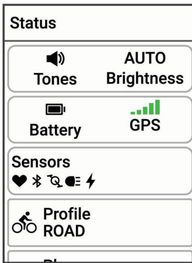
Si el ícono parpadea, significa que el dispositivo está buscando señal. Si el ícono permanece fijo, significa que se ha encontrado señal o que el sensor está conectado. Puedes seleccionar cualquier ícono para cambiar la configuración.
