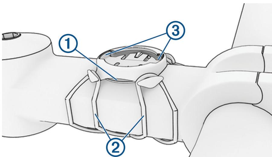
3 Coloca el soporte para bicicleta en la potencia de la bicicleta.
