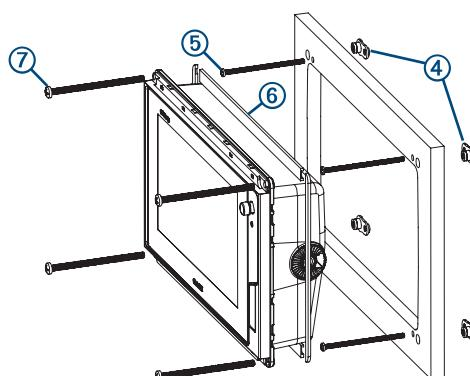
17 小さい穴を小さい小ねじ⑤で締めて、ナットプレートと取り付け面を固定します。
