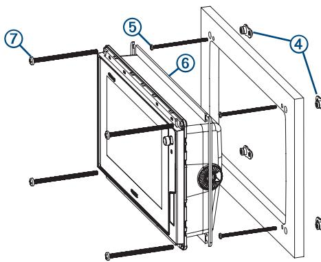
17 Fixez les plaques de montage à la surface de montage en plaçant les petites vis mécaniques fournies ⑤ dans les petits trous.
