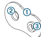
Le trou le plus petit ③ sur la platine doit être aligné sur le plus petit trou du modèle.
