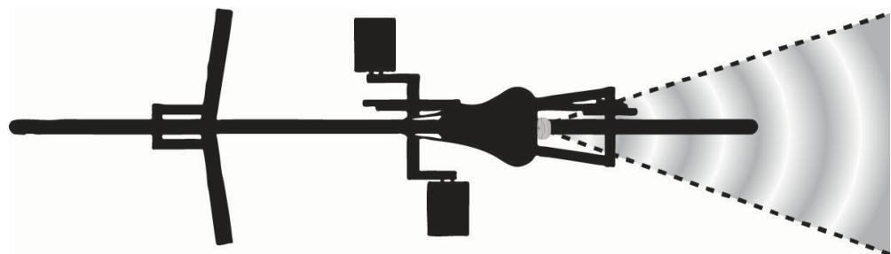
**REMARQUE :** si l'appareil est installé avec un angle vers la droite ou vers la gauche, le radar ne peut pas suivre correctement les véhicules qui s'approchent.
