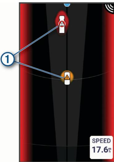
L'icône du véhicule se déplace vers le haut et traverse l'écran à mesure que le véhicule s'approche de vous, afin de vous indiquer sa position par rapport à vous.
