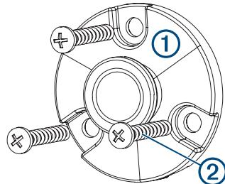
3 使用 3 毫米 ( $1/8$  英寸) 钻头钻出安装孔。
