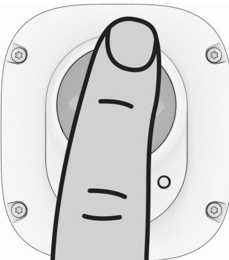
Il LED di stato lampeggia e il dispositivo si accende.
