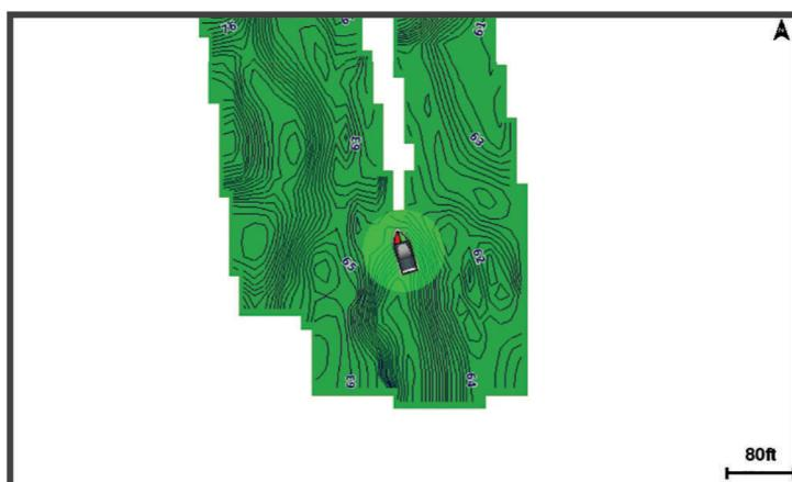
Um círculo verde indica uma velocidade inferior a 16 km/h (10 mph), além de boas profundidade e posição do GPS. Um círculo amarelo indica uma velocidade entre 16 e 32 km/h (10 e 20 mph), além de boas profundidade e posição do GPS. Um círculo vermelho indica velocidade acima de 32 km/h (20 mph), além de má profundidade ou posição do GPS.
